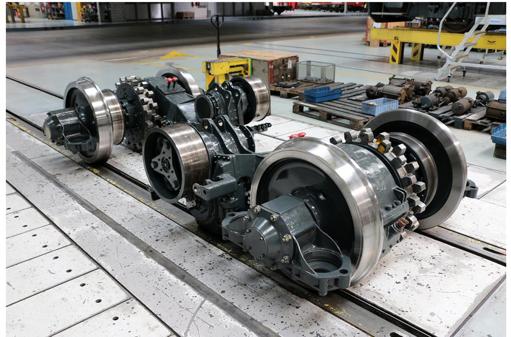
Zahnrad-Achsen mit Bremstrommeln
