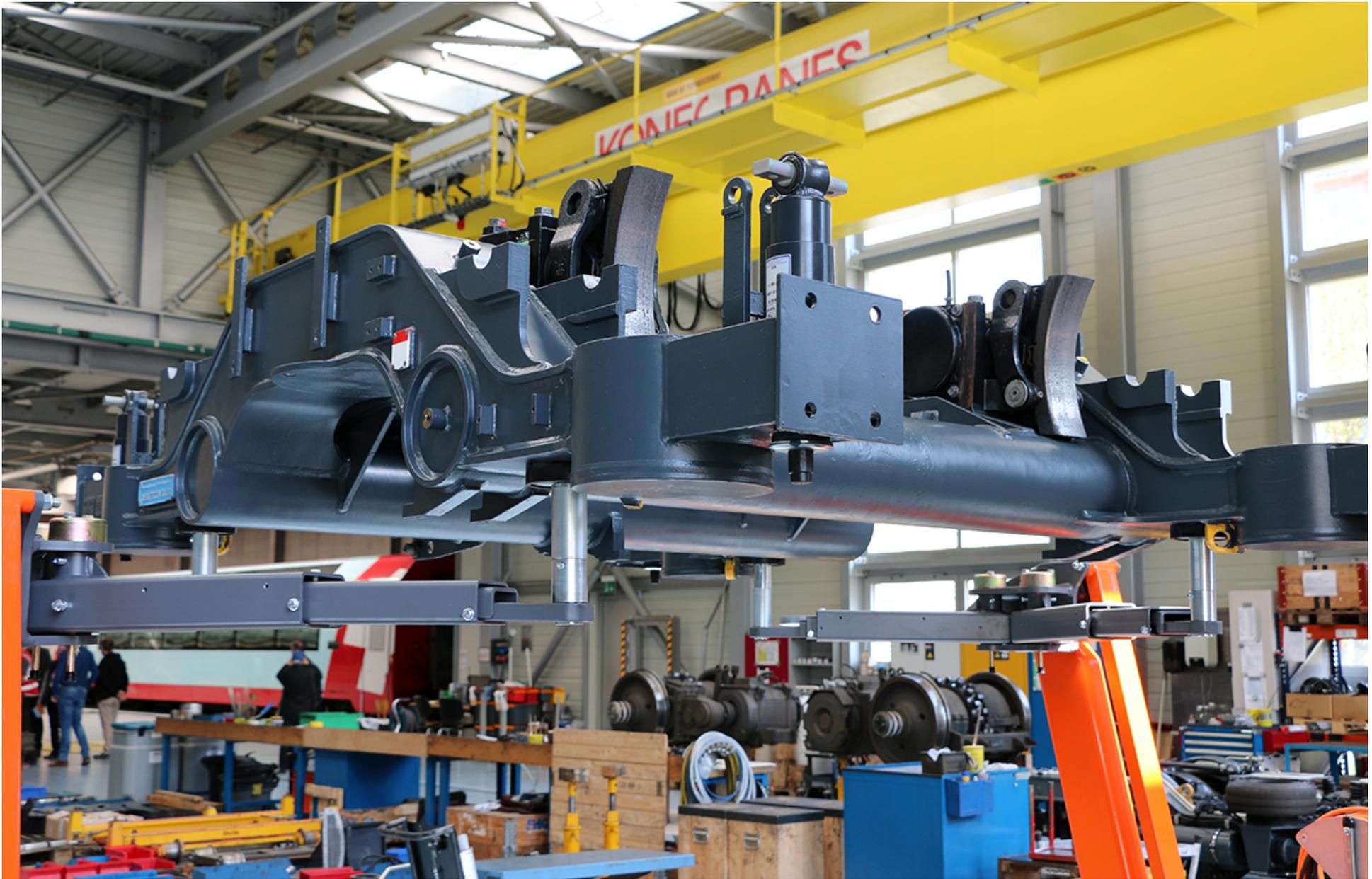
Laufdrehgestell-Rahmen, nach unten gedreht auf Hubtisch (Triebzug KOMET / Shuttle)
