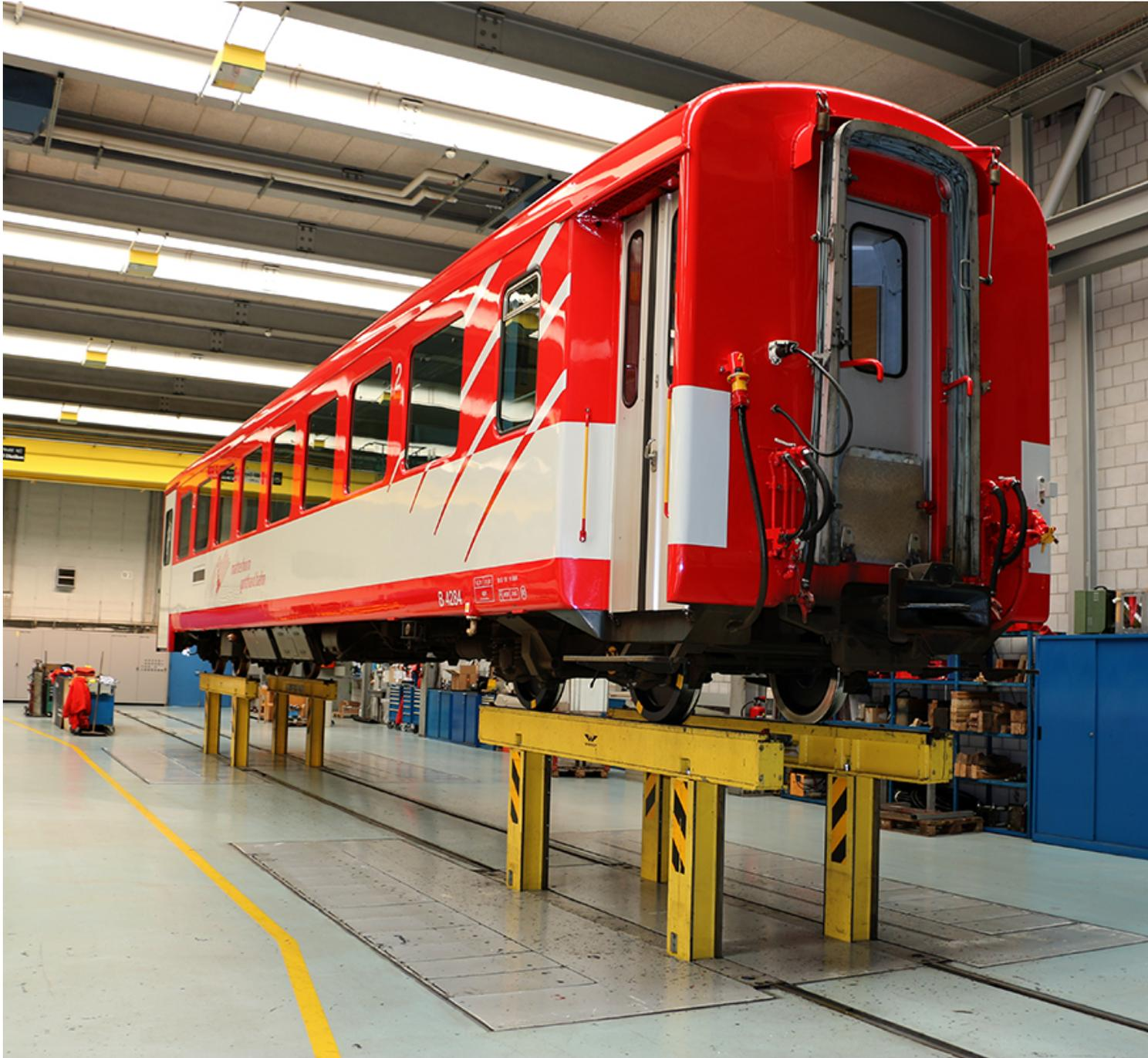
Der 1980 in Dienst gestellte Reisezugwagen 2.Klasse B 4284 ist umfassend umgebaut worden. Er erhielt zwei neue Einstiegstüren mit einer lichten Breite von 1 Meter sowie ein Mehrzweckabteil, das Platz für Fahrräder oder Skis / Schlitten (etc.) bietet.
