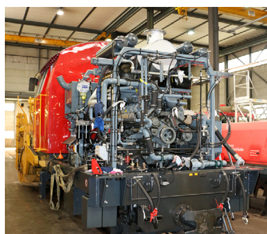
Neu umgebaute Schneeschleuder Xrotm 4936 (Typ Beilhack)
