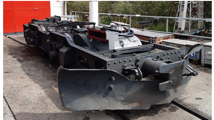
Drehgestell der HGe 4/4 I Nr. 36 in Realp DFB Zwei Fotos: Stephan Stauber
