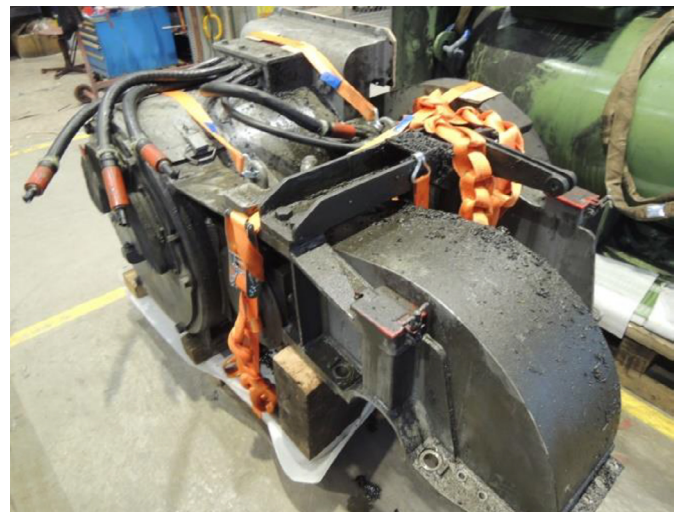
Der beschädigte Elektromotor Nr. 29 (Fabrikat MFO)
