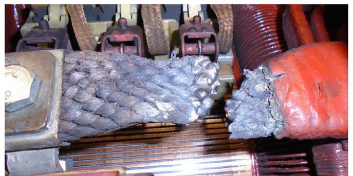
Der durchgeschmolzene Bürstenbrückanschluss
